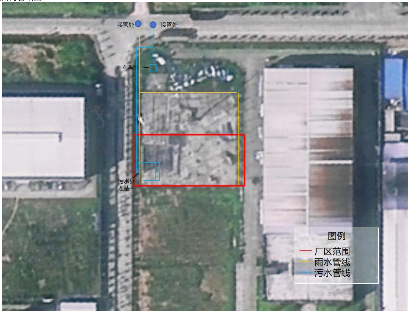
附图 6 厂区雨污管线图
